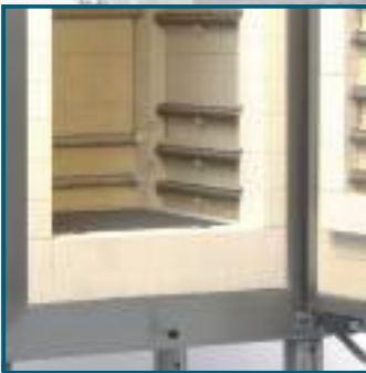
Extrem fester Feuerleichtstein ASTM 26 in mechanisch sehr stark beanspruchten Regionen Extremely solid fire brick ASTM 26 in mechanical very strongly claimed regions
