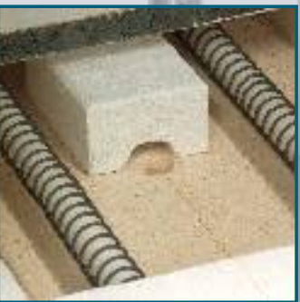
SIC Bodenabdeckung der Heizspiralen mit besten Wärmeleitfähigkeiten SIC base cover of the heating elements with best heat conductance
