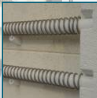
Kanthal-Heizspiralen mit niedriger Oberflächenbelastung garantieren lange Lebensdauer Kanthal heating elements with low surface load guarantee long lifespan
