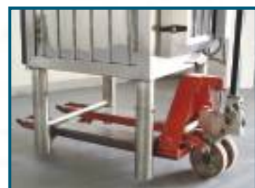
Untergestell mit Querstrebe für leichten Transport mittels Hubwagen Underframe with cross-brace for the easy transport with fork-lift
