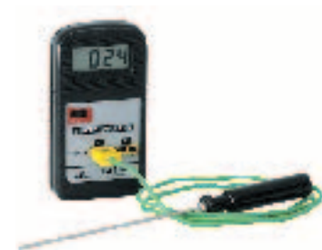
Temperaturmessgerät für RAKU 100, einfach zu bedienen, Temperaturfühler NiCr-Ni, Anzeige von 20 - 1200 °C, Anschlussmöglichkeit für zweiten Fühler mit Umschaltung der Anzeige
