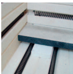
Bodenabdeckung aus SIC-Platten, wärmedurchlässig und robust.
